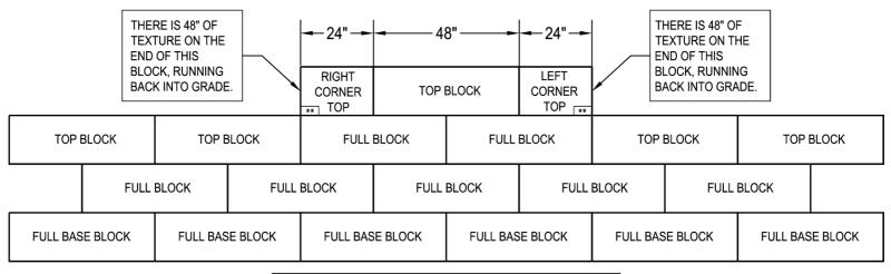
\*\* NOTE: APPROXIMATLEY 7" OF THE TONGUE OF THE FULL BLOCK DIRECTLY BENEATH THE CORNER TOP BLOCK MUST BE CUT OFF. HOWEVER, NO SHIM IS REQUIRED (AS IS THE CASE IN THE STANDARD PLACEMENT OF A CORNER TOP BLOCK).
